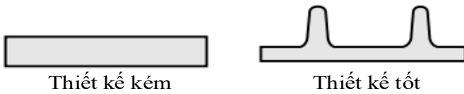
Hình 1.2: Thiết kế thành mỏng đồng nhất và ngược lại
